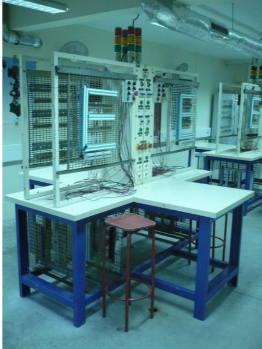
Banc de câblage électrique
