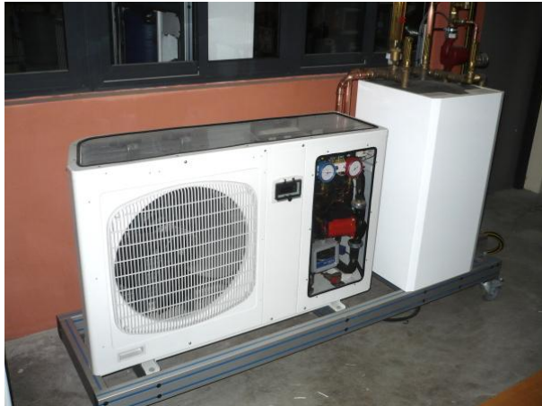
Banc didactique groupe de production d'eau glacée
